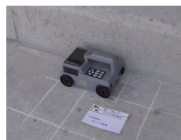
①鉄筋探査工 (RC レーダー探査)
